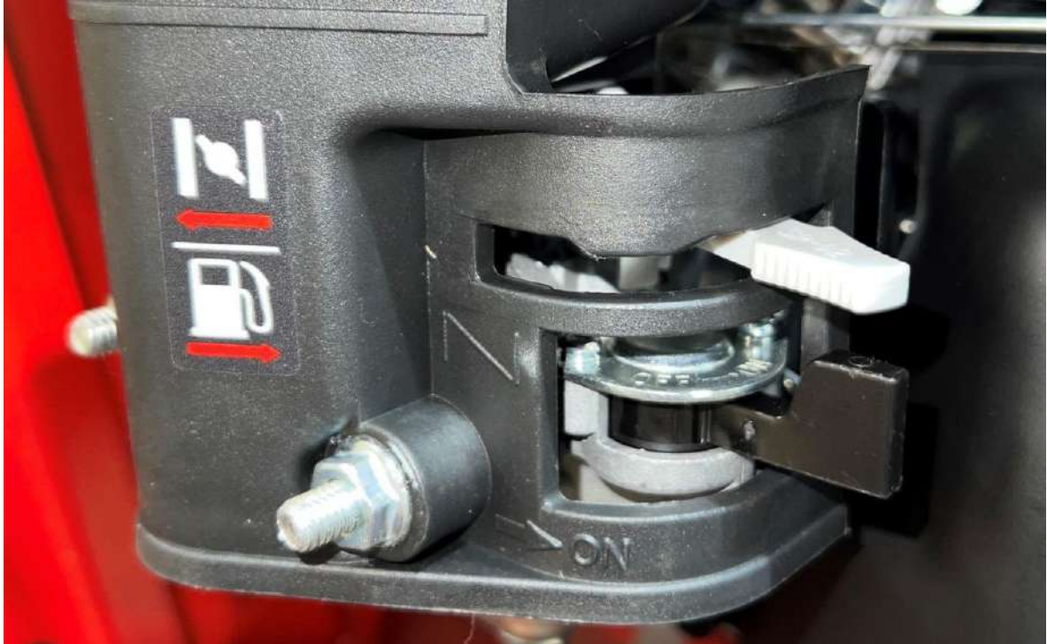
Рисунок 20. Важіль повітряної заслінки у відкритому положенні
