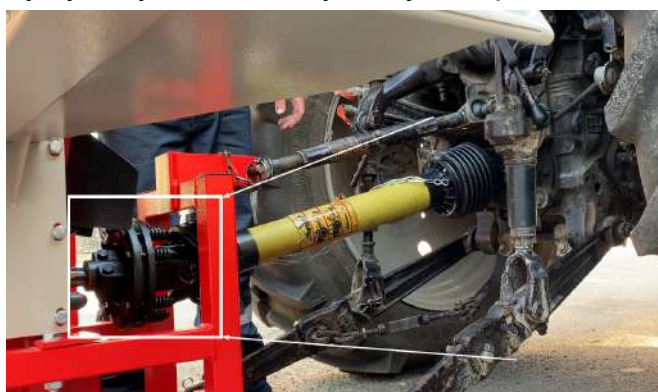
Рисунок 22. Розміщення фрикційної муфти на карданному валі
