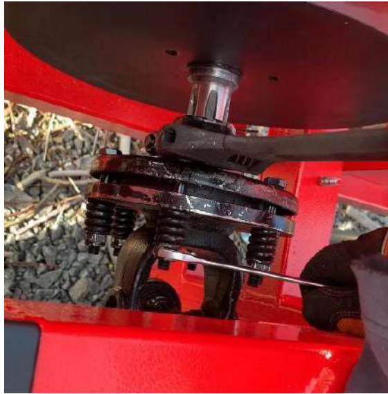
Рисунок 24. Налаштування фрикційної муфти
