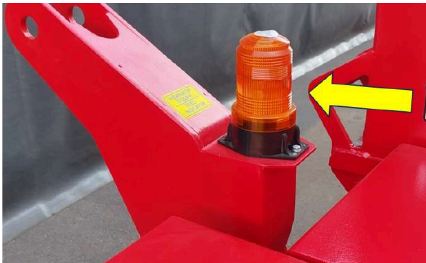
Рисунок 28 Місце встановлення пробліскового маячка
